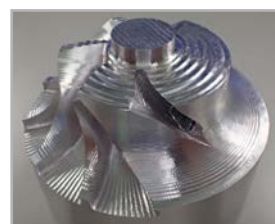
Rottura durante la lavorazione
